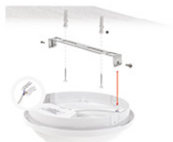
Mocowanie śrubą od boku Side screw mounting
